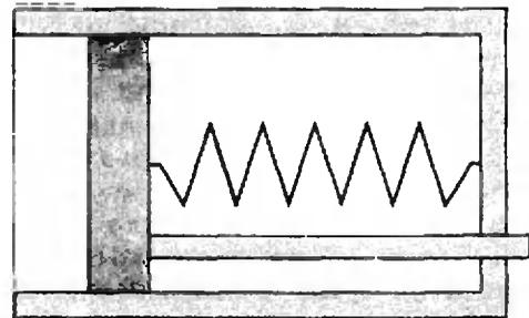
Рис. 1. Схема индикатора Викакса.
