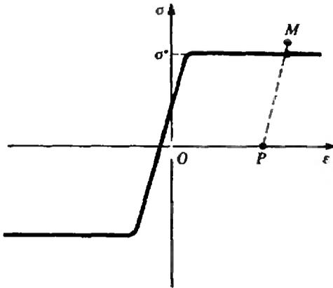
Рис. 2. График зависимости между напряжением и деформацией. При напряжениях  $|\sigma| < \sigma^*$  металл упруг, при больших напряжениях — пластичен. Если нагрузить образец до напряжения, соответствующего точке  $M$ , и после этого уменьшать напряжения до нуля, деформации будут изменяться так, как показано пунктиром.  $OP$  соответствует остаточной пластической деформации.
