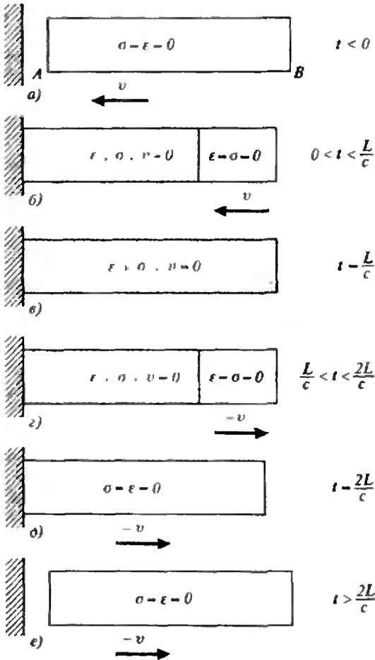
Рис. 4. Соударение стержня с жесткой преградой.
