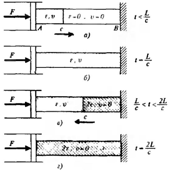
Рис. 5. Мгновенная нагрузка на стержень с закрепленным противоположным концом (модель индикатора Виккерса).
