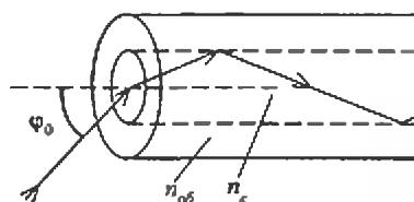
Рис. 3. Распределение световых лучей в двухслойном волоконном световоде
