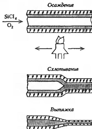
Рис. 4. Основные этапы изготовления кварцевого двухслойного световода
