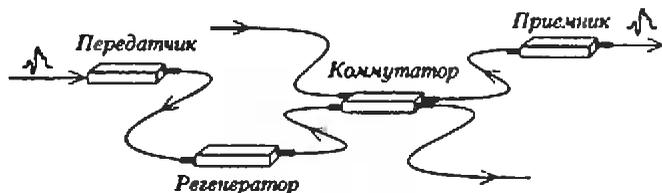
Рис. 1. Фрагмент волоконно-оптической системы связи
