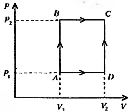
ся количество теплоты  $15,5 \text{ кДж}$ . Какое количество теплоты сообщается газу в процессе ADC, если  $V_1 = 10 \text{ л}$ ,  $V_2 = 20 \text{ л}$ ,  $p_1 = 100 \text{ кПа}$ ,  $p_2 = 300 \text{ кПа}$ ?
