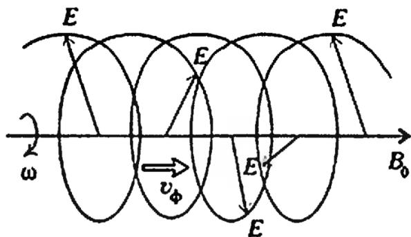
Рис.2. Спиральная волна, распространяющаяся в плазме вдоль постоянного магнитного поля  $B_0$  с фазовой скоростью  $v_\phi$ . Конец вектора  $\vec{E}$  описывает спираль, вращаясь с угловой скоростью  $\omega$
