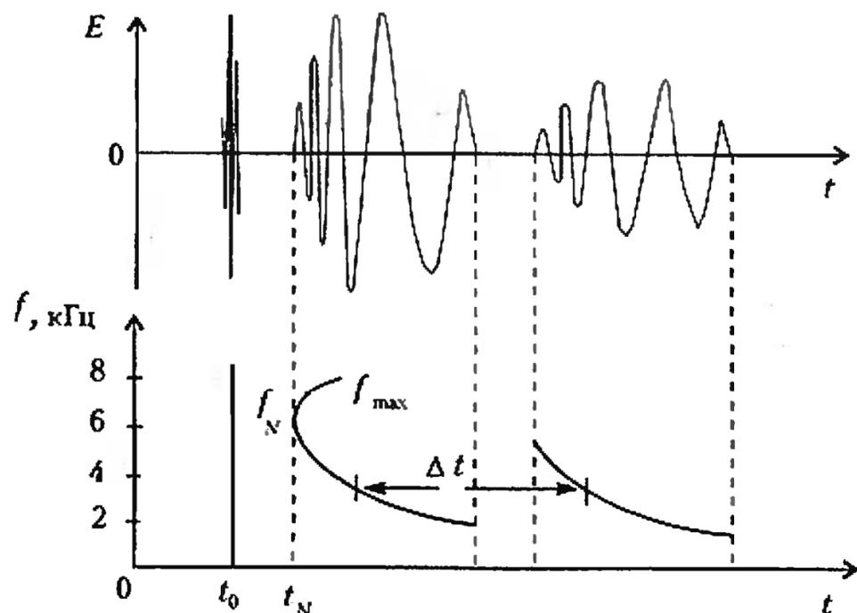
Рис.4. Свистящий атмосферик (сверху) и его спектрограмма. В момент  $t_0$  произошел разряд молнии, который возбудил одновременно все частоты (вертикальная линия на нижнем графике); в момент  $t_N$  появился «нос» атмосферика. Спустя некоторое время  $\Delta t$  приходит сигнал, отраженный от магнитосопряженной точки в другом полушарии
