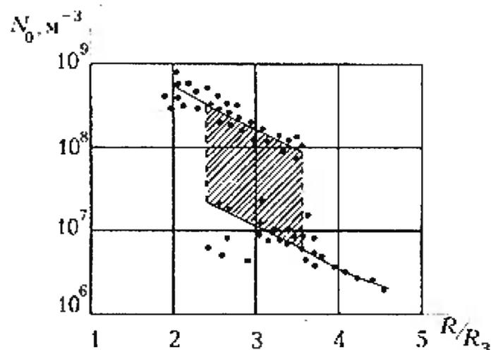
Рис. 5. Резкое изменение электронной концентрации («колесо») на границе внутренней области магнитосферы (заштрихованная область). Экспериментальные точки получены с помощью свистящих атмосфериков. Расстояние от Земли выражено в земных радиусах
