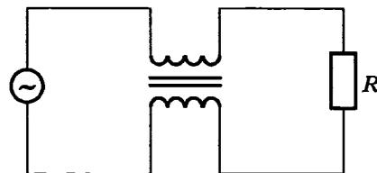
По цепи катушка – резистор – катушка течет некоторый ток. В зависимости от того как включены в цепь катушки (можно поменять местами выводы одной из катушек и все изменить), магнитные поля токов могут складываться друг с другом или вычитаться.
