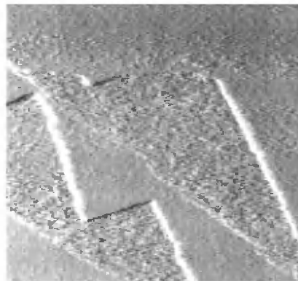
Рис.5. Соседние молекулярные слои роста имеют различную шероховатость, что хорошо видно в атомно-силовой микроскоп. Размер кадра 2 × 2 мкм
