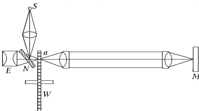
Определение скорости света методом Физо
