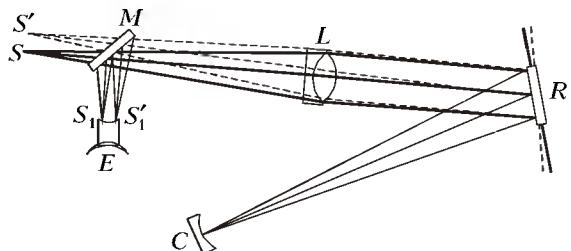
Измерение скорости света методом вращающегося зеркала (метод Фуко)
