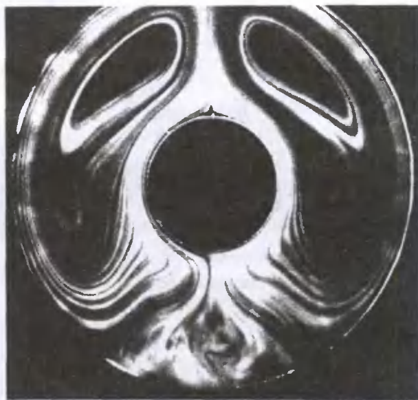
Рис. 2. Линии тока в конвективном движении между соосными цилиндрами
