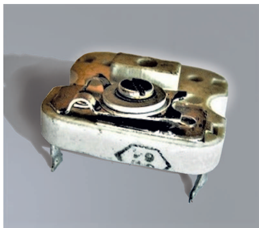
Рис. 4. Подстроечный конденсатор, верхняя пластина – подвижная
