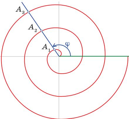
На рисунке зелёным цветом показано начальное положение луча, синим цветом – положение луча после поворота на угол  $\varphi$ , а также на угол  $\varphi + 360^\circ$ ,  $\varphi + 720^\circ$  и т. д. За каждый полный оборот луча точка
