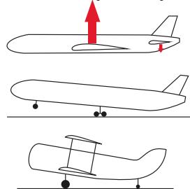
2. Чтобы самолёт набрал высоту, ему нужно задрать нос. Так как крылья прилагают силу к центру самолёта, то, управляя только оперением на крыльях, пилоты не могут повернуть самолёт, задрав его нос или хвост. Нужно толкать за «край» самолёта, далеко от центра тяжести. Как и при взлёте, оперируя оперением на хвосте, пилоты создают давление на хвост, направленное вниз.
