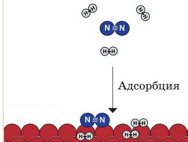
На поверхности катализатора молекулы разделяются на атомы
