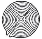
При нагревании, напротив, внешний слой стремится расширяться – отделяется от сердцевины трещиной вдоль одного из колец, как на рисунке справа.
