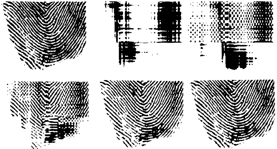
Рис. 6.5. Аппроксимация изображения с помощью SVD: (а) исходные данные (отпечаток пальца); (б) используется 1 сингулярное число; (в) используется 2 сингулярных числа; (г) используется 4 сингулярных числа; (д) используется 10 сингулярных чисел; (е) используется 20 сингулярных чисел.
