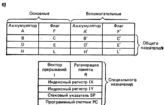
Рис. 18. Структура центрального процессора (а) и внутренних регистров (б) микро-ЭВМ Z80
