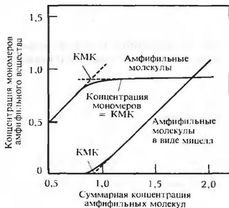
РИС. 25.6. Распределение амфифильных молекул между мономерной и мицеллярной формами в зависимости от полной концентрации молекул. (Tanford C., The Hydrophobic Effect , New York, Wiley, 1973.)
