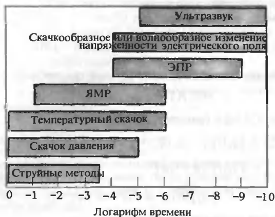
РИС. 16.7. Временная шкала различных методов изучения быстрых реакций (Hammes, Schimmel, 1970).
