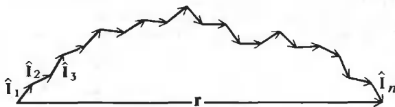
РИС. 18.2. Вектор r , соединяющий концы цепи, равен сумме векторов связей.
