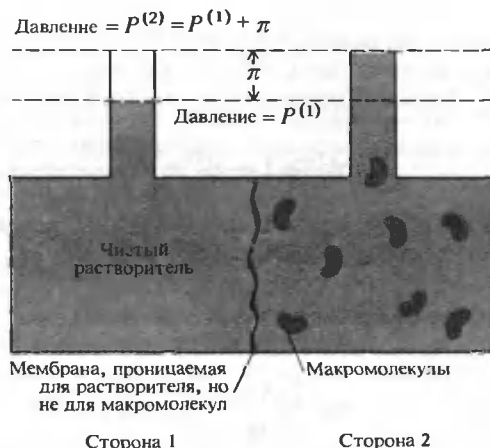
РИС. 25.3. Осмотическое давление \pi = P^{(2)} - P^{(1)} равно разности давлений с двух сторон мембраны.
