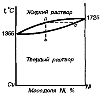
Рис. 6.5. Диаграмма плавления сплава Cu – Ni
