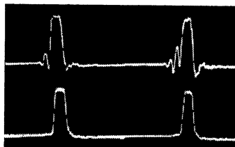
Рис. 49. Осциллограммы импульсов длительностью 1 мкс после прохождения через линию на время задержки 5 и 10 мкс: сверху для линии СЛЗ-2, внизу для линии ЛЗМ-0,5-1200.
