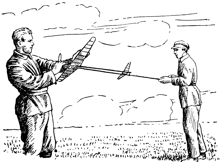
Рис. 54. Способ закручивания резиномотора на полные обороты
