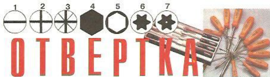
1. Прямая лопатка. 2. Прямой крестообразный наконечник. 3. Конический крестообразный наконечник. 4. Наконечник под наружный шестигранник. 5. Наконечник под внутренний шестигранник. 6. Наконечник под шестигранную звезду. 7. Наконечник под шестигранную звезду с центральным штифтом.
