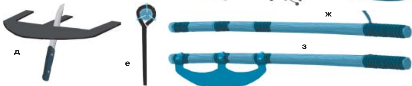
Рис. 4. Детали секиры и необходимые материалы: а — рукоятка; б — лист резины; в — гвозди; г — лента из кожзаменителя; д — лезвие секиры; е — штифт для крепления лезвия; ж — обмотка рукоятки; з — общий вид секиры.
