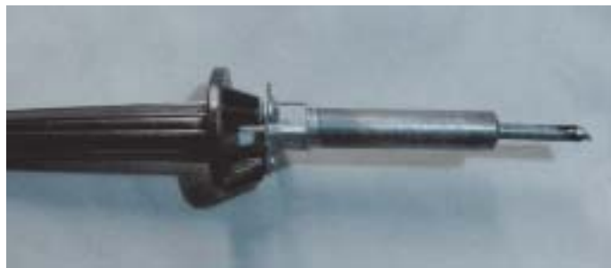
Рис. 3. Паяльник ЭПСН-25 на напряжение 12 В.
