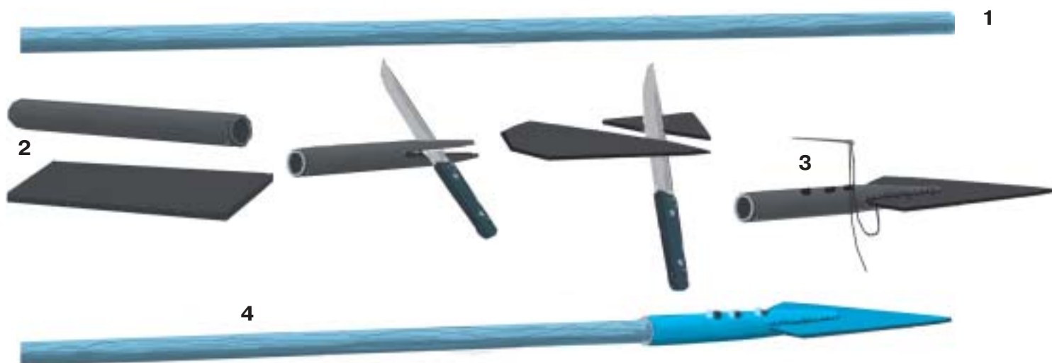
Рис. 5. Изготовление копья: 1 — рукоятка; 2 — детали наконечника; 3 — наконечник в сборе; 4 — общий вид копья.
