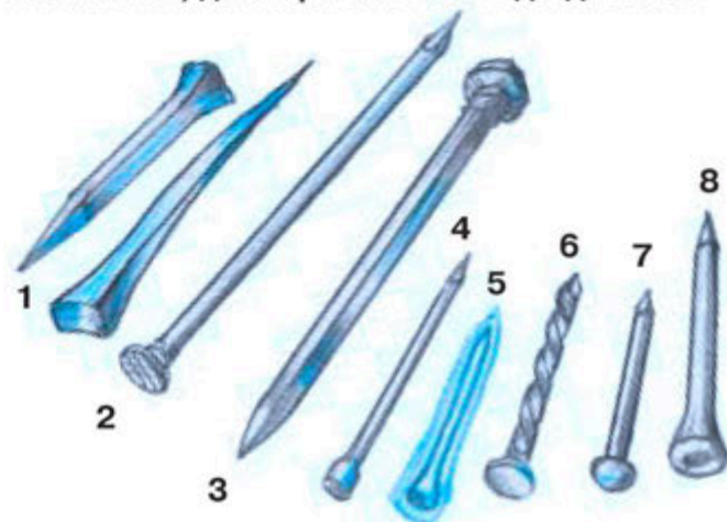
Рис. 1: 1. Подковные. 2. Крепежные круглые. 3. Крепежные квадратные. 4. Финишные. 5. С золотистым покрытием. 6. Винтовые. 7. Каленые, для кирпича. 8. Гвозди-дюбели.
