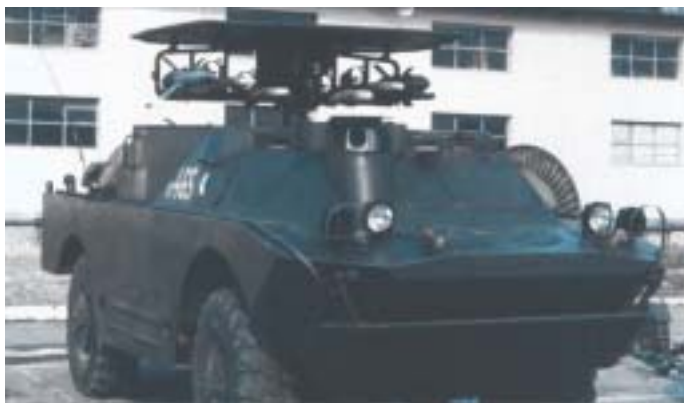
Рис. 3. Установка противотанковых управляемых ракет на БРДМ-2-ПТУР.
