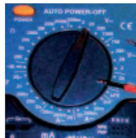
Многопозиционный переключатель параметров мультиметра.
