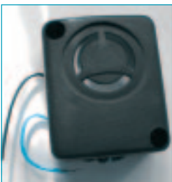
Рис. 4. Общий вид капсуля-излучателя со встроенным звуковым генератором.
