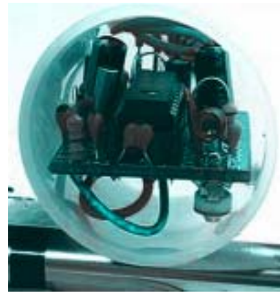
Рис. 5. Компоновка элементов передатчика в корпусе.
