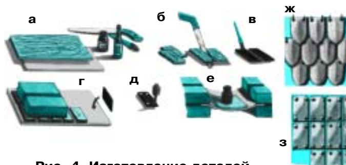
Рис. 4. Изготовление деталей пластинчатого доспеха: а — исходные материалы и инструмент; б — изготовление пластинок; в — окраска и покрытие эпоксидной смолой; г — высушивание под гнетом; д — сверление отверстий; е — изготовление выпуклых пластин; ж — крепления в виде чешуи; з — крепление на заклепках.
