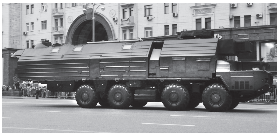
Так выглядит машина обеспечения боевого дежурства для бесперебойной подачи энергии центральному посту и орудиям комплекса «Берег».
