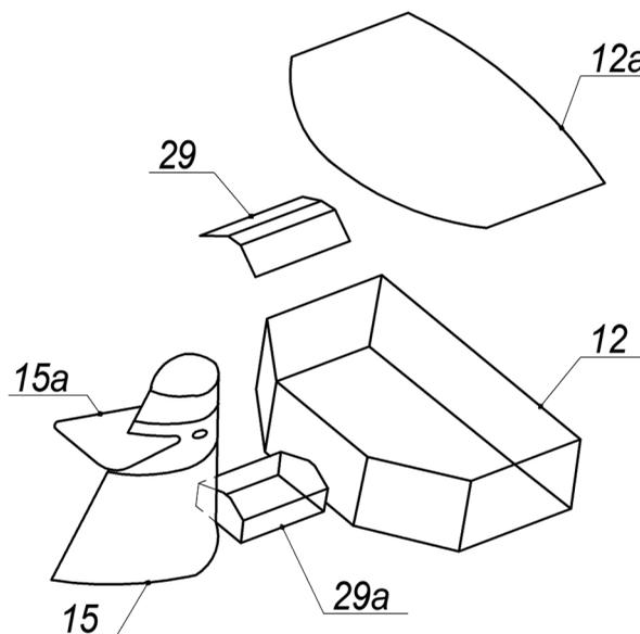
**Рис. 6. Схема сборки верхней надстройки и дымовой трубы.**
