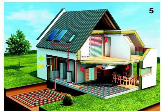
Рис. 1. Котельная с тепловым насосом.
