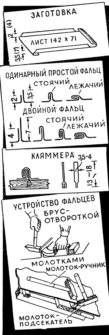
Рис. 3. Соединение листов стальной кровли
