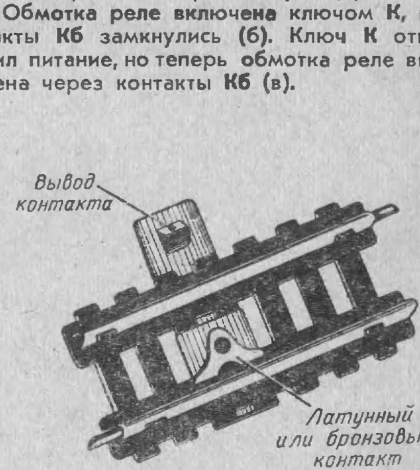
Рис. 10. Участок пути дороги с дополнительным контактом.
