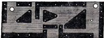
Монтажная плата конвертера.
