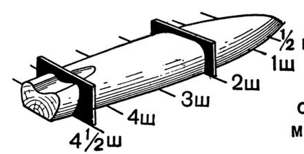
Проверка шаблонами при обработке корпуса модели бронекатера
