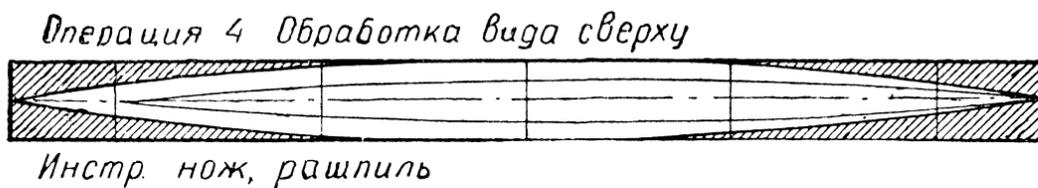
Проверка шаблонами при обработке корпуса модели подводной лодки
