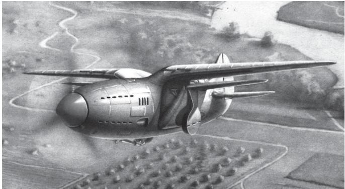
Истребитель монобиплан ИС-4 — неординарная летательная машина, сконструированная в первой половине прошлого века. В авиации одной из важных летных характеристик является отношение веса самолета к площади крыла. Этим определяются летные качества воздушных аппаратов — при выигрыше в подъемной силе проигрывает скорость. Поэтому самолеты-бипланы с большой площадью крыла имели малую скорость отрыва и небольшую скорость горизонтального полета. У монопланов все было наоборот.
