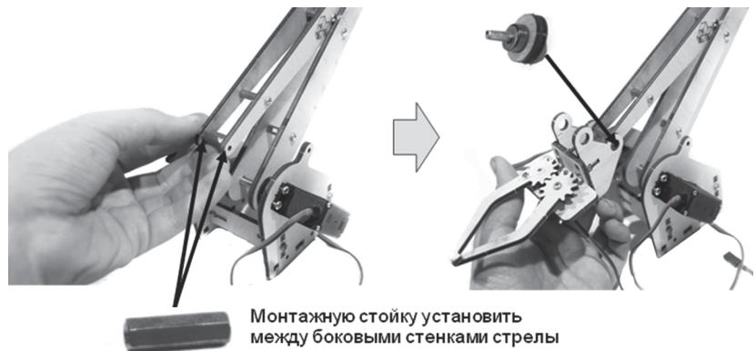
**Рис. 9. Установка клемши.**
