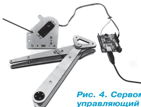
**Рис. 4. Сервомотор, управляющий большим рычагом.**
