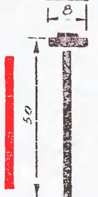
РЫЧАГ БАСКИРОВКИ ПЛЕНКИ И СПУСКА ЗАТВОРОВ / РАЗМЕРЫ ОРИЕНТИРОВОЧНОЕ РЫЧАГ ПОДГОНЕТСЯ В ПРОЦЕССЕ НАЛАДКИ /
