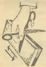
**КАК ТОЧИТЬ НОЖНИЦЫ.** Чтобы наточить ножницы, надо иметь либо оселок, либо брусок или точильный камень. На рисунке показано, как нужно держать и перемещать лезвие ножниц при заточке. Сначала нужно точить на грубой стороне бруска, а затем — на более тонкой. Заточивать лезвие нужно одинаково и равномерно по всей его длине.
