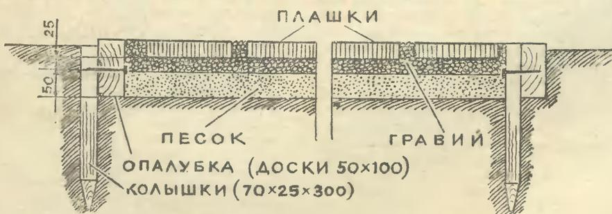
(рис. 4). Неплохо после этого полить дорожку водой — песок и гравий еще лучше уплотнятся (рис. 5). Как только дорожка просохнет, можете укладывать спилы (рис. 6). Постарайтесь плотнее подогнать плашки друг к другу. Проверьте длинной рейкой, ровно ли и на одном ли уровне они лежат (рис. 7).
