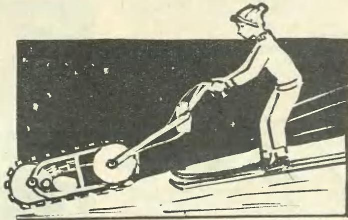
чением 6x220 мм, а траки выполнены из прямослойных березовых реек сечением 35x75 мм и длиной 1260 мм, усиленных гребнями, выгнутыми из стальной полосы толщиной 3 мм. Собирают гусеницу на болтах с гайками резьбой М6, размещенных с шагом, соответствующим шагу зацепов.
