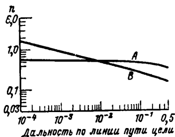
Рис. 5.18. График коэффициента перегрузки n при пропорциональном сближении
