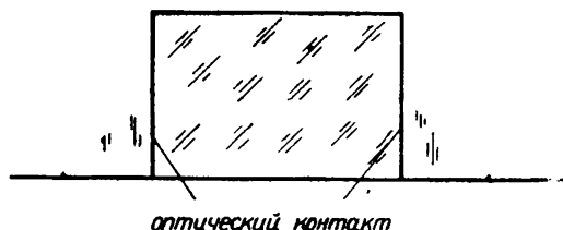
Фиг. 11. Крепление призм при помощи оптического контакта
