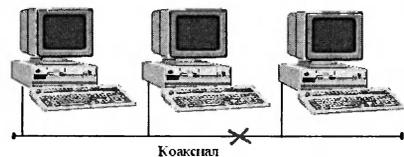
наторы — специальные сопротивления-заглушки по 50 Ом, которые гасят отраженную от концов кабеля электромагнитную волну. Длина кабеля “тонкий Ethernet” не должна превышать 150 метров в одном сегменте.
