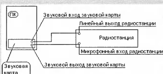
Схема подключения ПК к радиостанции
