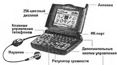
достаточны. Цветной TFT-дисплей отображает до 256 цветов, имеется 8 Мбайт памяти для данных и программ. По программным возможностям аппарат похож на Ericsson R380: основные встроенные приложения, WAP-браузер, возможность работы с почтой по протоколу POP3 и синхронизации данных с компьютером. В качестве операционной системы используется WisdomT OS 5.0.
