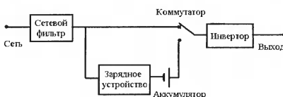
Блок-схема ИБП типа line-interactive
