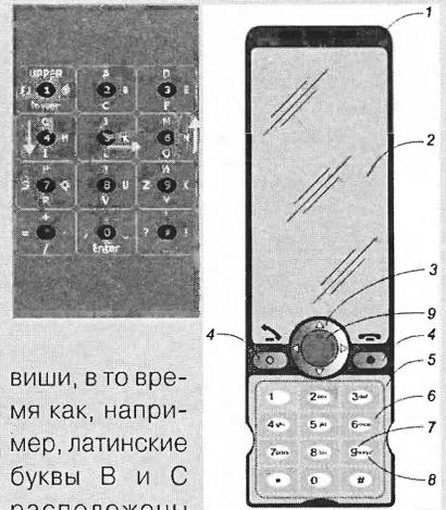
Получается, что с помощью каждой клавиши стандартной телефонной клавиатуры в МК можно ввести, по крайней мере, пять символов (один — вертикальным нажатием или касанием, и четыре — касательным движением). Можно и больше, если задействовать движения от периферии клавиши к ее центру, а не только из центра к периферии, но это менее понятно и удобно.
