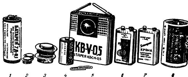
Рис. 17. Источники питания транзисторных приемников.
