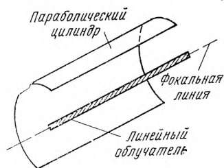
Рис. 8.12. Эскиз зеркальной антенны с параболическим цилиндром
