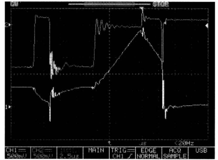
Рис. 9.3. Эпоуры напряжения и тока импульсного разряда при срабатывании защиты от тока: а — при резком нарастании тока (срабатывание защиты, отключение напряжения и тока на время 300 мкс); б — левая часть — снижение напряжения и тока в паузе (5 мкс); правая часть — при развитии дуги — резкое снижение напряжения при плавном нарастании тока до уровня срабатывания защиты и далее — полное отключение напряжения при плавном снижении тока до нуля
