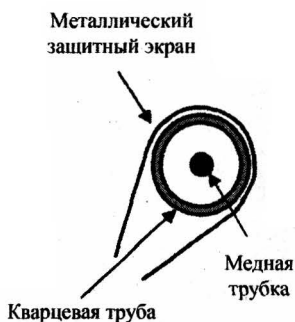
Рис. 3.42. Схема коаксиальной СВЧ системы [57]
