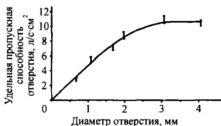
Рис. 8.13. Измеренная величина удельной пропускной способности отверстия в трубке [23]
