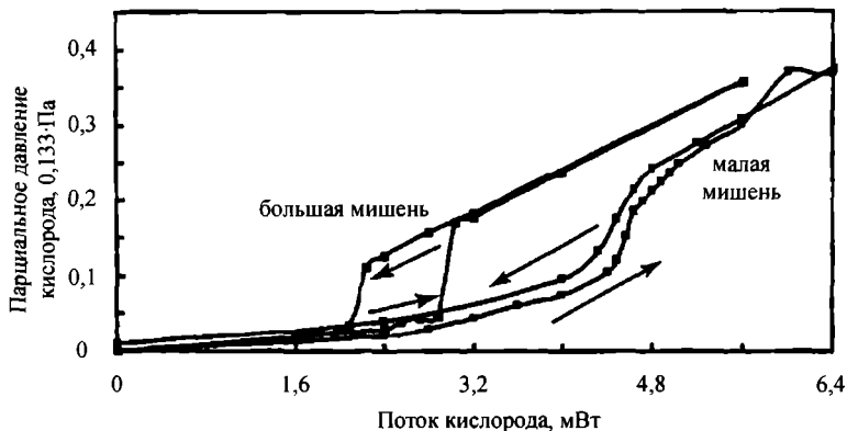
Рис. 4.7. Экспериментальные результаты для парциального давления кислорода при различных величинах эффективных площадей зон эрозии мишени [18]
