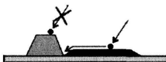
Рис. 6.9. Схема роста в условиях Т зоны [2]. Механизм роста 2D показан как основной, при этом механизм роста 3D не рассматривается. Светло-серым цветом окрашено зерно, ориентированное в направлении геометрически наиболее быстрого роста, перпендикулярного подложке
