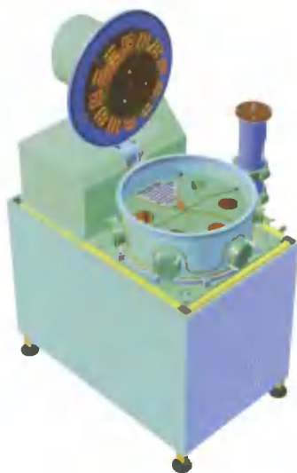
Рис. 6.5. Конструкторская модель установки «Каролина Д-12 А» с открытой крышкой камеры.
