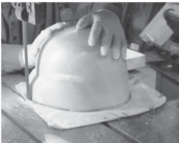
Рис. 11.25. Обрезка кромки каски
