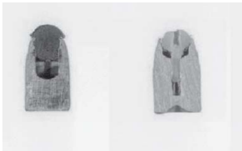
Рис. 2.27. Пуля .357 Магнум, деформированная материалом Gold Flex
