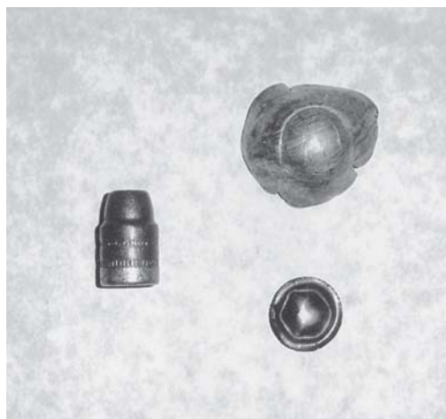
Рис. 2.24. Пуля Магнум калибра .44 до и после удара по легкой волокнистой броне
