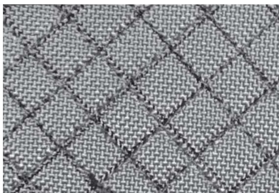
Рис. 2.42. Простегивание мягкого противобаллистического пакета
