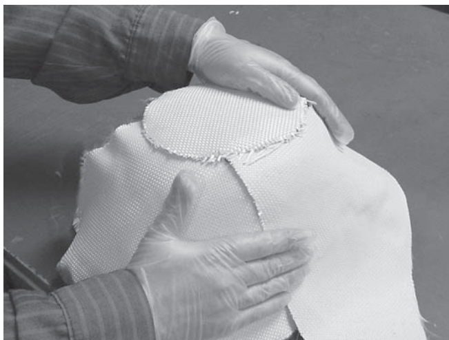
Рис. 11.5. Выкладка ткани на пресс-форму каски
