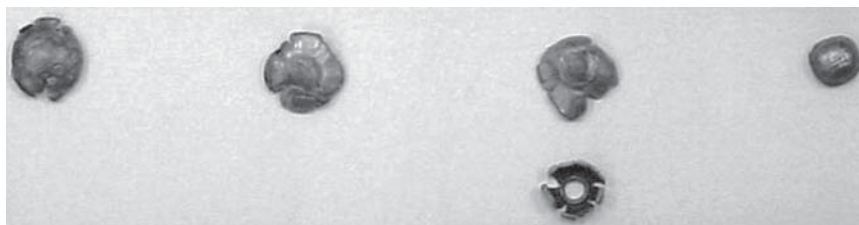
Рис. 2.43. Деформация пули тканым бронепакетом и поперечно ориентированным композитом на основе арамидных волокон
