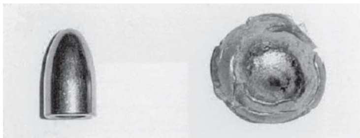
Рис. 2.28. 9 мм пуля с полной металлической оболочкой до и после соударения с облегченным противобаллистическим композитом
