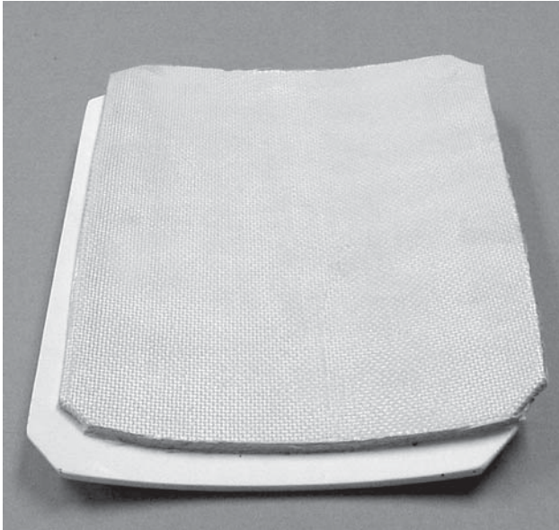
Рис. 11.28. Сформованный поддерживающий композиционный материал, готовый к приклеиванию лицевой керамической пластины
