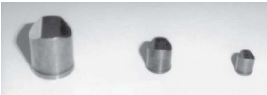
Рис. 2.5. Имитаторы осколка 50, 30 и 22 калибра
