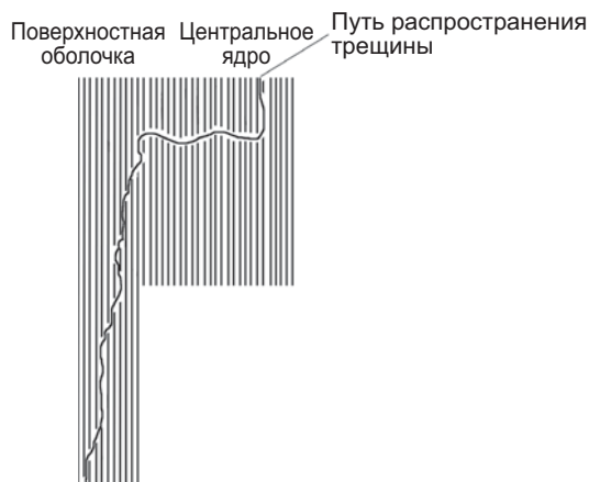
Рис. 7.17. Распространение трещины в волокне
