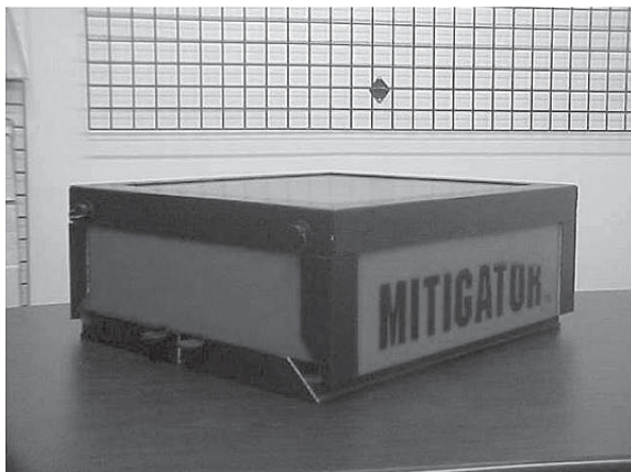
Рис. 13.9. Устройство «Mitigator» для уничтожения бомб цилиндрической формы
