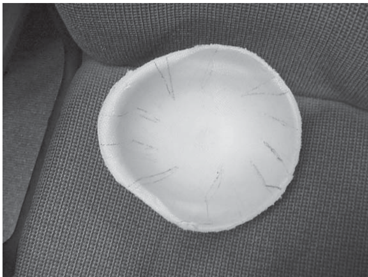
Рис. 11.24. Корпус каски после формования
