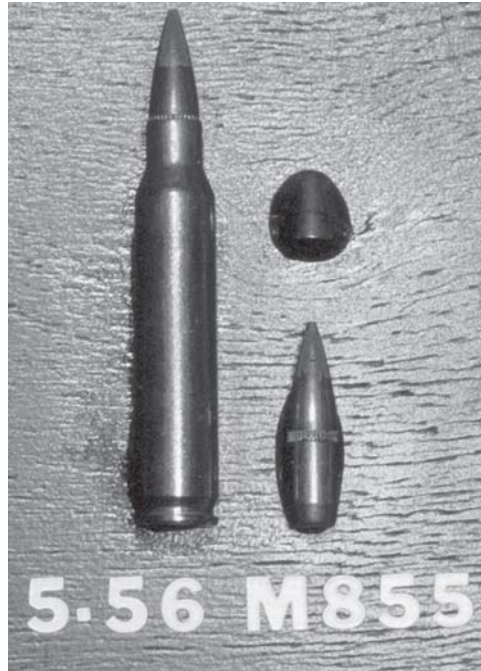
Рис. 2.17. Пуля M855 со стальным сердечником
