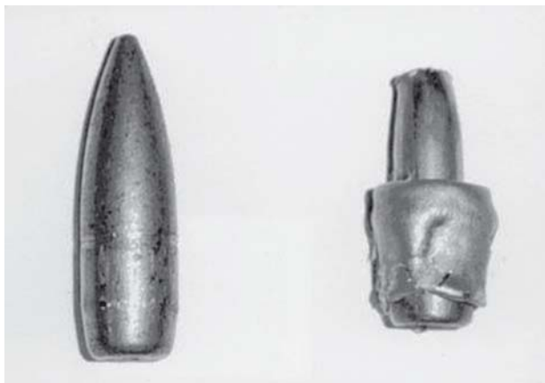
Рис. 2.29. Пуля АК 47 до и после удара по легкой композитной броне с керамическим лицевым слоем
