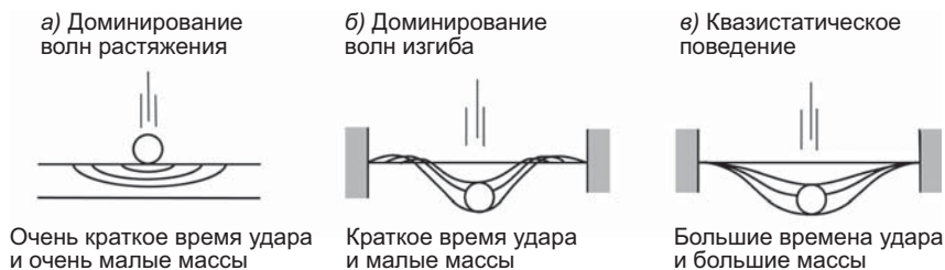
Рис. 3.22. Классификация типов соударения при различных скоростях движения снарядов (Ollson, 2001)
