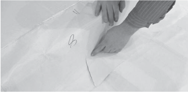
Рис. 11.7. Размещение детали, перекрывающей разрез ткани
