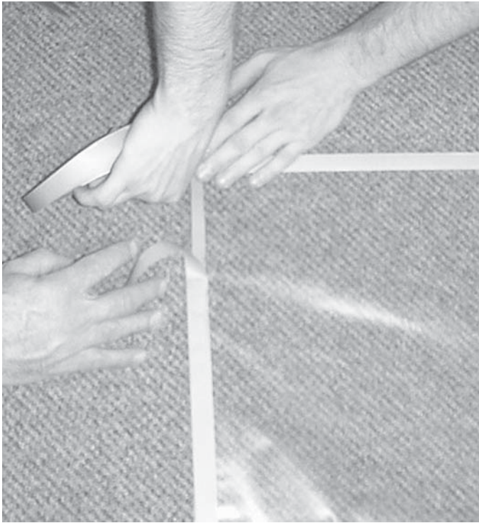
Рис. 11.12. Нанесение герметизирующей пленки при формировании в мешке
