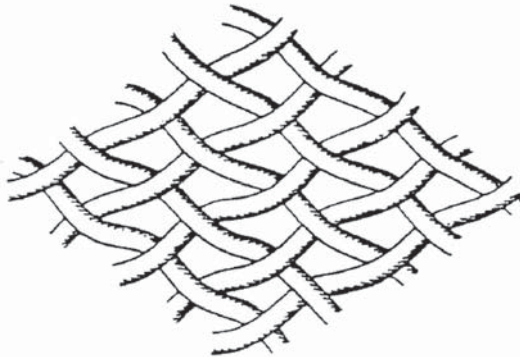
Рис. 1.1. Структура типичной ткани, используемой для производства брони
