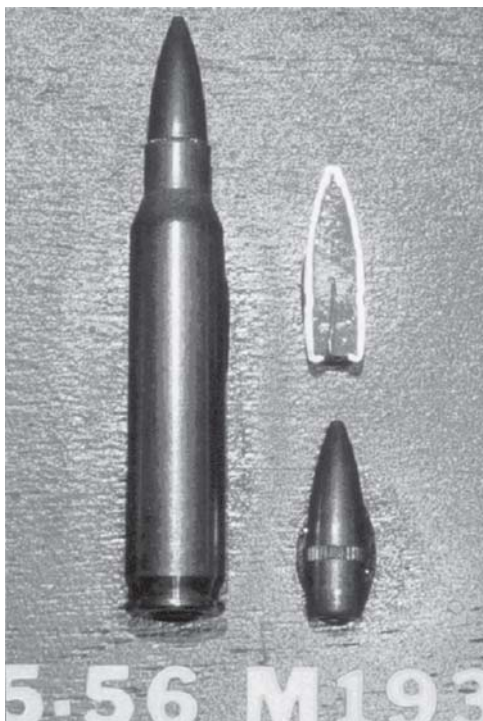
Рис. 2.19. Форма патрона и строение пули M193
