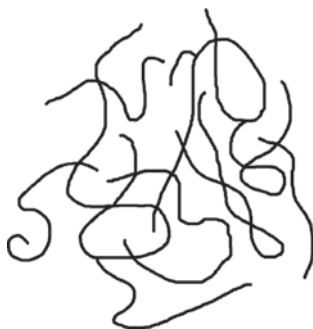
Рис. 7.10. Клубки гибкоцепных полимерных волокон
