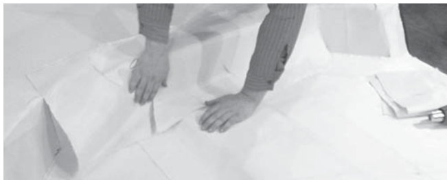
Рис. 11.6. Накладывание слоя на форму
