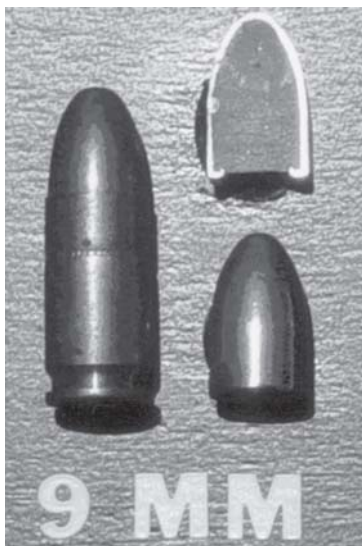
Рис. 2.12. 9 мм пуля с металлической оболочкой. На поперечном сечении видны свинцовая пуля и металлическая оболочка
