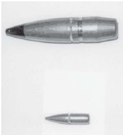
Рис. 2.22. Бронебойные пули наименьшего (.22) и наибольшего (50) калибра
