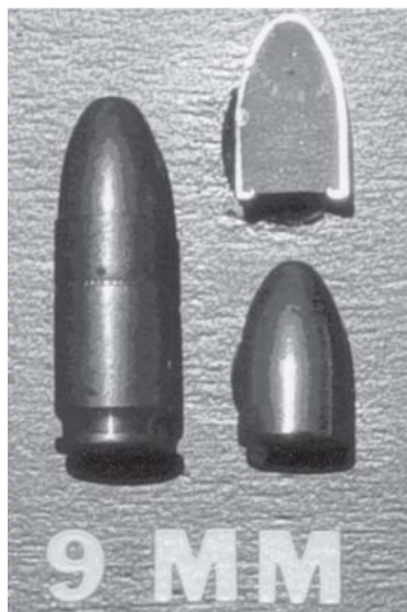
Рис. 2.23. 9 мм свинцовая пуля с металлической оболочкой
