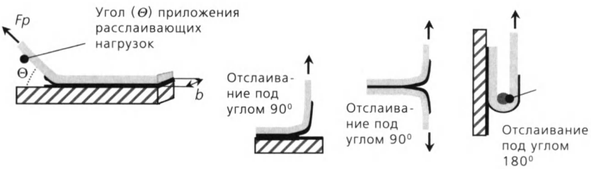
Рис. 7.3. Образцы при испытании на отслаивание
