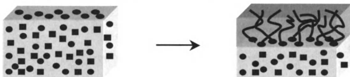
Рис. 3.13. Образование поперечных связей с участием или без участия подложки (склеиваемой поверхности)
