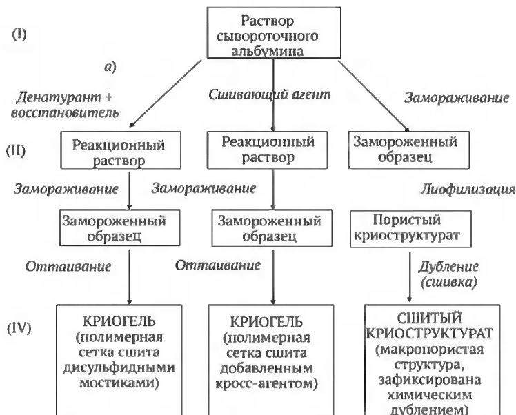
Рис. 4.4. Принципиальные схемы формирования криогелей и криоструктуратов на основе сывороточного альбумина [30]
