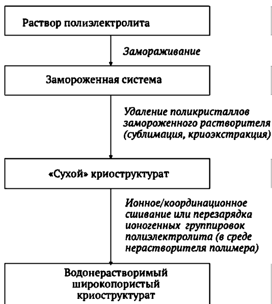
Рис. 3.14. Общая схема формирования ионных/координационных криоструктуратов [1]
