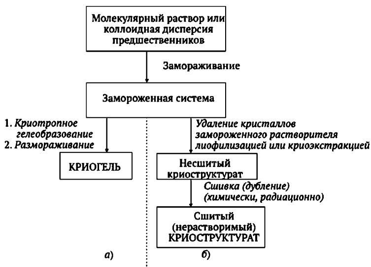
Рис. 3.1. Принципиальная схема формирования полимерных криогелей а ) и криоструктуратов б ) [1]
