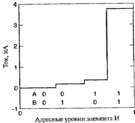
Рис. 13.23. Реально полученная таблица истинности логического элемента И, изготовленного из двух молекулярных переключателей A и B , соединенных как показано сверху. График демонстрирует, что выходной сигнал (большой ток) появляется только в том случае, когда оба переключателя находятся во включенном состоянии ( A = 1 и B = 1 ). Адресные уровни, помещенные внизу графика, показывают возможные состояния переключателей A и B : включено (1) и выключено (0).
