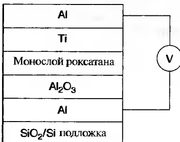
Рис. 13.21. Поперечное сечение молекулярного переключателя, изготовленного методом литографии на основе роксатана, молекула которого показана на рис. 13.20. Монослой роксатана помещается между алюминиевыми электродами, находящимися на подложке. Верхний электрод покрыт слоем титана, а нижний — слоем оксида алюминия.
