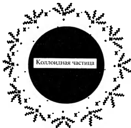
Рис. 10.22. Металлическая коллоидная частица, стабилизированная молекулами галлада тетраалкиламмония \text{NR}_4\text{X} .
