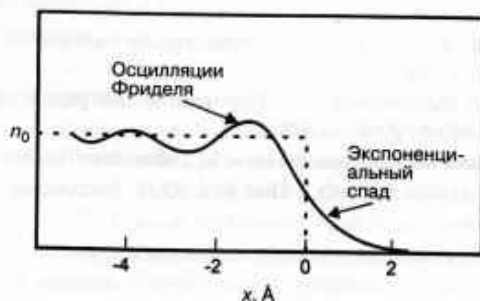
Рис. 2.1. Схема изменения распределения плотности поверхностного заряда (осцилляции Фриделя) вдоль направления, перпендикулярного поверхности электронного газа со спиновой поляризацией, соответствующего проводимости электронов в металле. Рисунок взят из работы [1] (см. также ссылки [2–4]) с разрешения издательства Wiley
