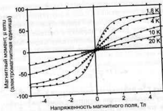
Рис. 5.1. Поведение магнитного момента образца Mn , легированного наночастицами сульфида кадмия. С изменением напряженности поля наблюдается насыщение, описываемое S-образной (сигмоидной) кривой, характерной для парамагнитного состояния вещества. При температурах 10 и 20 К кривые становятся практически линейными при напряженности магнитного поля 5 Тл. Перепечатывается из работы [1] с разрешения РССР Owner Societies
