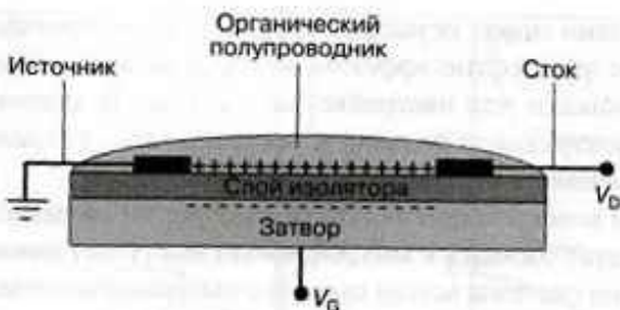
Рис. 4.4. Тонкопленочный полевой транзистор (FET). Подача отрицательного смещающего напряжения V_G на электрод затвора приводит к инжекции носителей заряда в органический полупроводник и возникновению двухмерного (2D) канала p -типа между источником и стоком, позволяющего проводить электроны при наложении напряжения стока V_D . Тонкий слой изолятора (обычно \text{SiO}_2 ) между затвором и органическим полупроводником предотвращает возникновение тока затвора. Полярность устройства может быть изменена на противоположную подбором соответствующего материала
