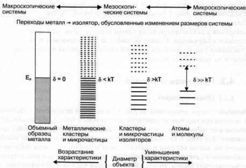
Рис. 4.6. Изменения ширины запрещенной зоны и плотности состояний в зависимости от числа атомов в системе. Параметр \delta означает ширину щели Кубо [14]. Перепечатывается из работы [12] с разрешения авторов
