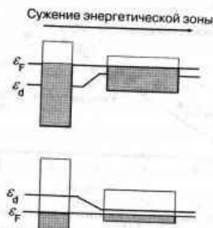
Рис. 10.10. Эффект сужения d-зоны энергетических уровней, вследствие чего центр этой зоны \epsilon_d смещается к уровню Ферми \epsilon_F . Обычно d-зона катализаторов на основе переходных металлов заполнена больше половины, поэтому сужение зоны соответствует возрастанию энергии и установлению нового равновесного значения степени заполнения уровней зоны, как показано в верхней части рисунка. Остальные пояснения приводятся в тексте. Перепечатывается из работы [1]
