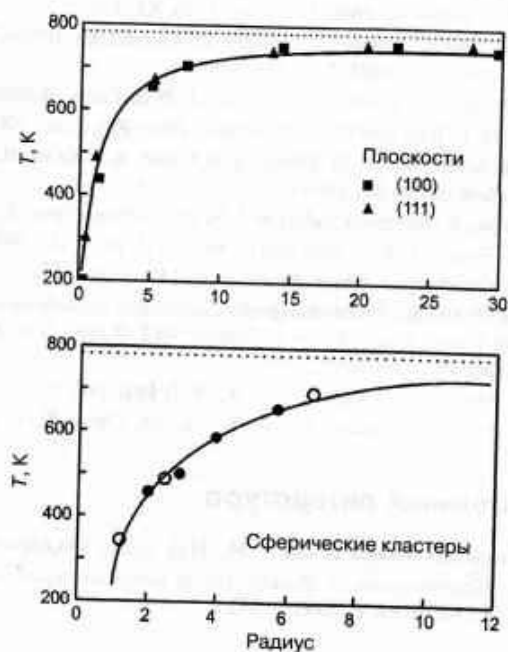
Рис. 9.1. Зависимость температуры плавления от толщины пленок (вверху) и радиуса сферических кластеров (внизу) из сплавов халькогенидов с составом \text{GeSb}_2\text{Te}_4 . Значения толщины и радиуса отнесены к постоянной решетки, пунктирная линия в верхней части соответствует температуре плавления объемной фазы. Перепечатывается из работы [1]. © 1997, TMS
