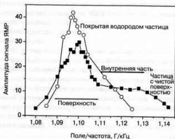
Рис. 5.25. Полученные по точкам спектры ЯМР для атомов ^{195}\text{Pt} в виде платинового катализатора, нанесенного на подложку анатаза. Частицы имеют диаметр 1,7 нм, содержание платины — 4,4 вес.%. По данным работы [43]
