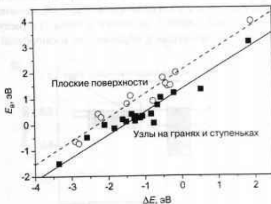
Рис. 10.9. Зависимости энергии активации от потенциальной энергии диссоциативной хемосорбции различных двухатомных молекул ( N_2 , CO, NO и O_2 ) для атомов металлов, расположенных на различных участках кристаллической поверхности. Светлые кружки соответствуют результатам расчетов для атомов плоских поверхностей с гранецентрированной кубической (111), плотной гексагональной (0001) и объемно-центрированной кубической (110) структурой, а черные квадратик — атомам на гранях и ступеньках структур, включая узлы решетки с координационным числом 5. Перепечатывается из работы [17]. © 2002, с разрешения издательства Elsevier
